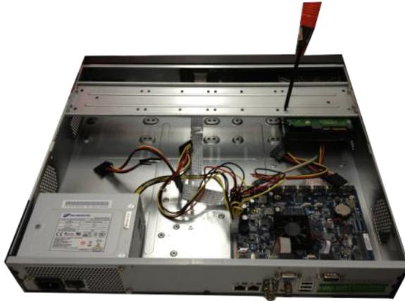
단계 3 메인보드와 HDD 포트에 각각 HDD 데이터 케이블을 연결하십시오. 장치의 전원 케이블을 풀어 전원 케이블의 다른 쪽 끝을 HDD 포트에 연결하십시오.
